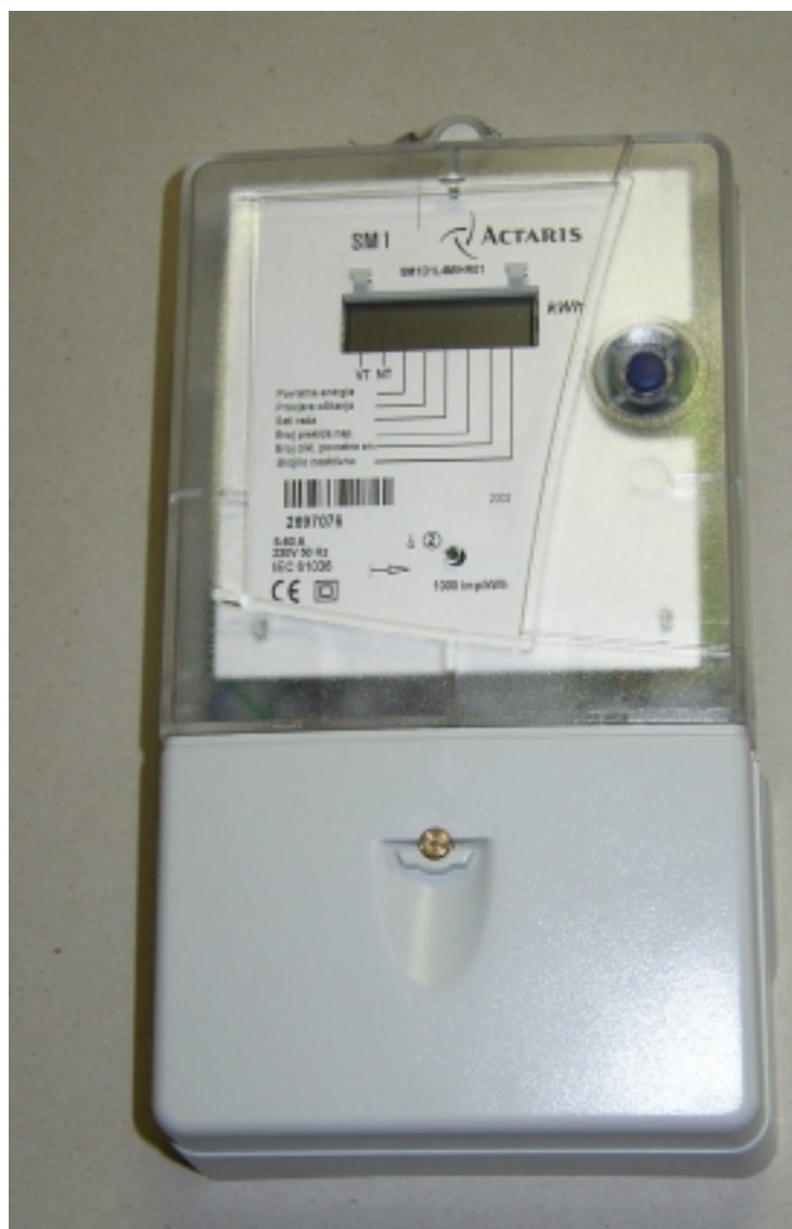
Slika 1. Slika jednofaznoga elektroničkog brojila električne energije tip SM1
